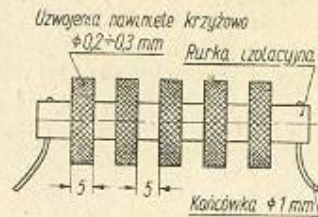
Rys. 2-4. Dławik wielkiej częstotliwości 2,5 mH
